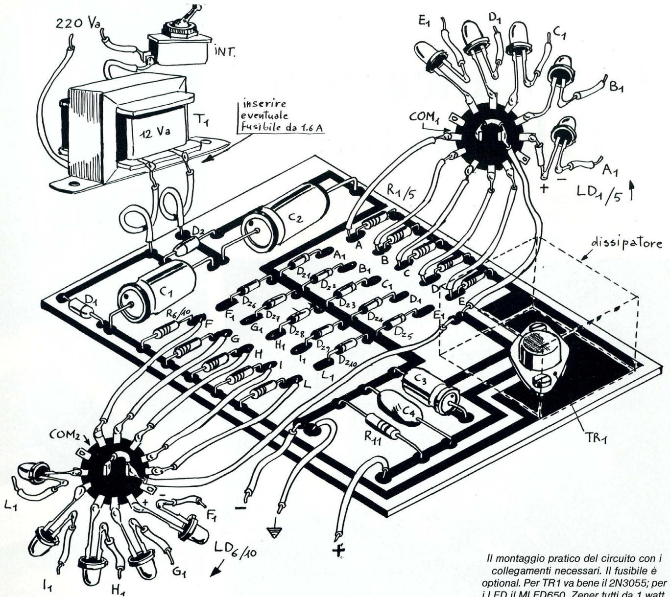
Il montaggio pratico del circuito con i collegamenti necessari. Il fusibile è optional. Per TR<sub>1</sub> va bene il 2N3055; per i LED il MLED650. Zener tutti da 1 watt.
