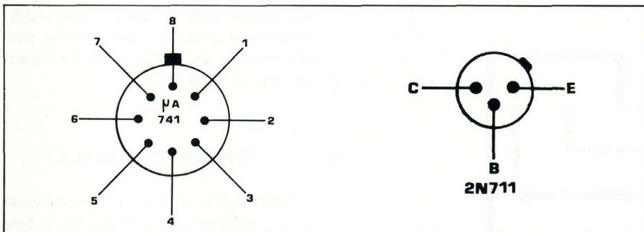
Per quanto riguarda l'integrato ed il transistor, si tratta di normale amministrazione, purchè si badi alle polarità e alle saldature che devono apparire lucide, tondeggianti e ben aderenti sia alla superficie ramata sia ai aeofori dei componenti elettronici.
