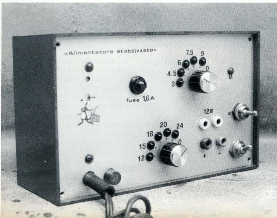
menti tra la basetta e i vari elementi del pannello (attenzione alla polarità dei led!), inserite un fusibile da 1,6A, controllate che tutto sia al posto giusto e nel modo giusto e date tensione: se non vi salta per aria il laboratorio vuol dire che tutto è a posto.
