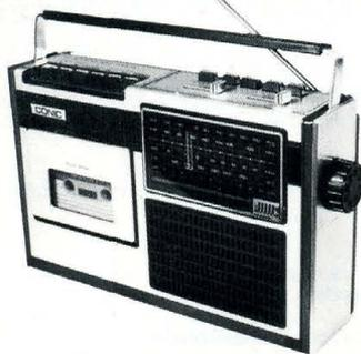
Microfono incorporato - Prese per microfono esterno, cuffia ed ausiliaria - Gamme di ricezione: AM 540-1610 KHz; FM 88-108 MHz; SW 6-18 MHz; LW 155-280 KHz - Potenza d'uscita: 1 W - Risposta di frequenza: 100-8000 Hz - Alimentazione: 6 Vc.c. oppure 220 V.c.a. - Dimensioni: 370 x 220 x 110 mm.
