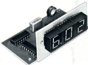
La tecnica digitale, che offre elevata precisione e chiarezza di lettura, è alla base di questo eccellente voltmetro a tre cifre per tensioni continue dal minimo di 1 mV al massimo di 999 V. La disposizione del circuito ne permette la collocazione in qualunque unità di misura, in sostituzione del tradizionale strumento da pannello.
